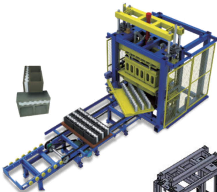
► 保温砌块苯板插入装置 Automatic Foam Plate Device 保温“砖”家
